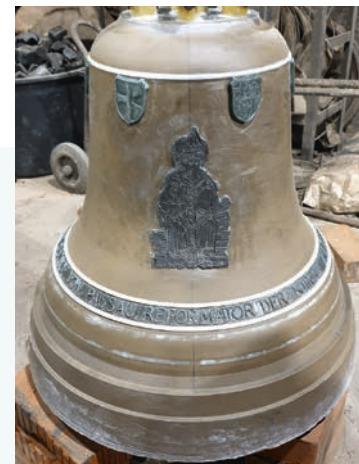
Falsche Glocke mit der aufgetragenen Glockenzier aus Wachs
